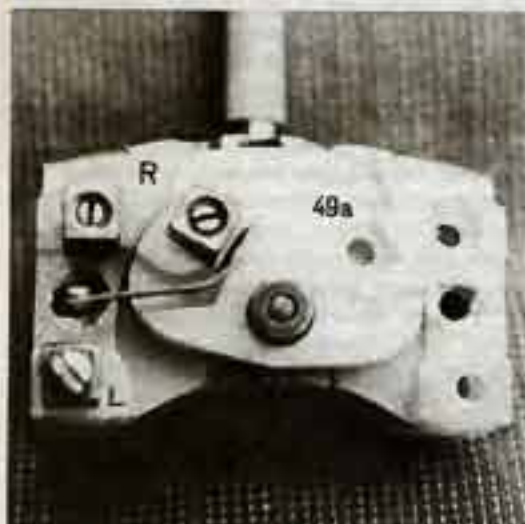
2 – Mit dem Einkreisblinkschalter ist nur die Standardausführung ausgestattet.
