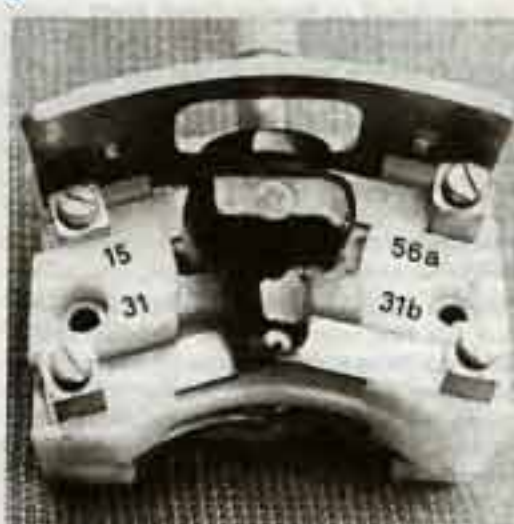
4 – Die Rückseite ist bei beiden Schalterausführungen gleich. Die Kontakte 31–31b schalten das Horn, 15–56a die Lichtlupe bzw. das Abblendrelais.
