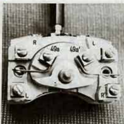
3 – Beim Zweikreisblinkschalter des 601 S und L schaltet die linke Kontaktgruppe 49a – L/R die Blinkleuchten, an der rechten 49a' – L'/R' ist das Parklicht angeschlossen.
