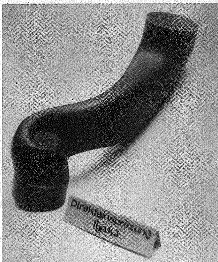
Bild 1 Modell des Einlaßdrallkanals am Motor 4 VD 12,5/10-6 SRL
