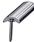
NL8 Deckleiste, 12 mm breit mit eingesetzten Nägeln, Nagel- abstand ca. 100 mm, Alu poliert, Länge 5 m EUR 6,00/m*
