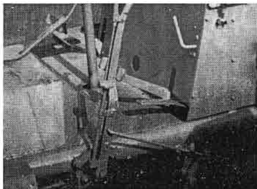
Bild 3. Fußhebelwerk
