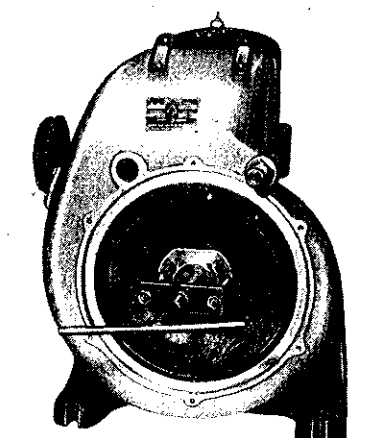
Bild 35. Nocken mittels Abziehvorrichtung abziehen
