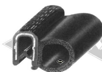
5001 Türabdichtung Klemmbereich 1,5-3,5 mm Wulst ca. 14 mm
